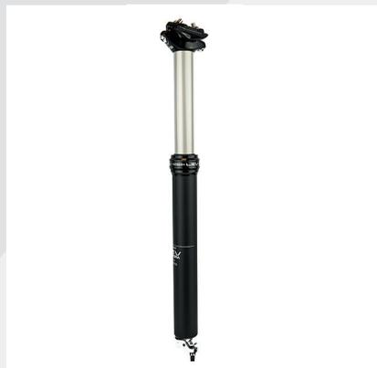
Die Nummer eins unter den absenkbaren Sattelstützen. Durch die Anlenkung des Auslösehebels am Schafft bewegt sich das Kabel beim Absenken nicht mehr mit und kann somit nicht mehr stören oder verklemmen. Der Sattel lässt sich in jeder gewünschten Position montieren. In allen Tests schneidet die KS LEV als beste absenkbare Sattelstütze ab. Erhältlich in den Durchmessern 27.2, 30.9, 31.6 und 34.9 mm sowie mit 100, 125 und 150 mm Hub. Mehr Sicherheit und mehr Fahrspass dank Kind Shock LEV!
