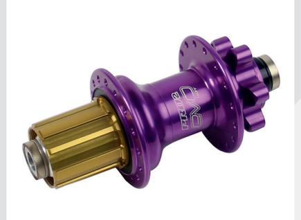
Hope hat die bereits 1000-fach bewährte MTB Nabe nochmals in Details verbessert. Alle Kugellager sind rostfrei und zudem aus Europäischer Produktion. Die 4 stabilen Klinken im Leerlauf greifen neu in einen Zahnring mit total 40 Zähne. Dadurch reagiert die Nabe noch schneller. Bekannt ist HOPE aber auch, dass es die Nabe mit allen möglichen und nötigen Achsoptionen gibt. Schnellspanner, Steckachse, usw. Neu gibt es die PRO-II EVO auch für Tandems, FAT-Bikes, etc etc.
