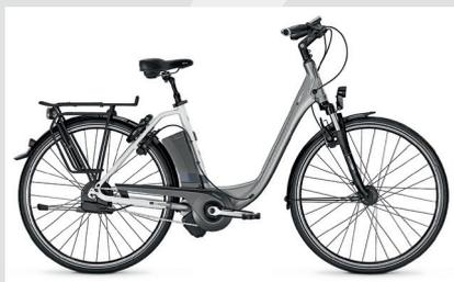
Eine Weltneuheit kommt von Kalkhoff mit dem E-Bike «Impulse Ergo NuVinci Harmony». Das Pedelec steuert die Motorunterstützung anhand der Pulsfrequenz des Fahrers. Ein kabelloser Brustgurt misst dazu die Herztöne des Fahrers, der zuvor seine Wunschbelastung eingestellt hat. Sinkt der Puls unter die definierte Grenze, lässt der E-Bike-Antrieb nach und der Fahrer muss sich stärker anstrengen. Sollte der Maximalherzschlag erreicht sein, gibt das Pedelec mehr Energie frei.
